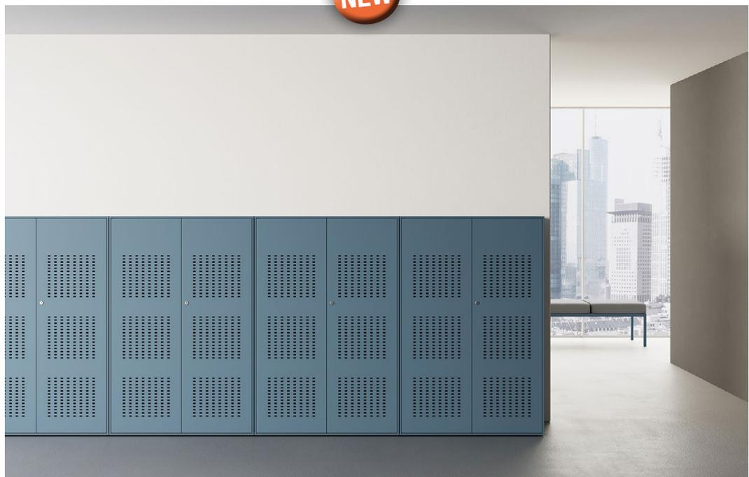
■ Carcassa armadio realizzato in struttura componibile autoportante, in lamiera d'acciaio 8/10 di prima scelta DC01 - UNI EN 10130, presso piegata. Spigoli esterni arrotondati con raggio di curvatura di 2 mm. Dotato di n°4 piedini livellatori. Verniciato a polveri elettrostatiche di resine epossipoliestere, previo trattamento di fosfosgrassaggio.
