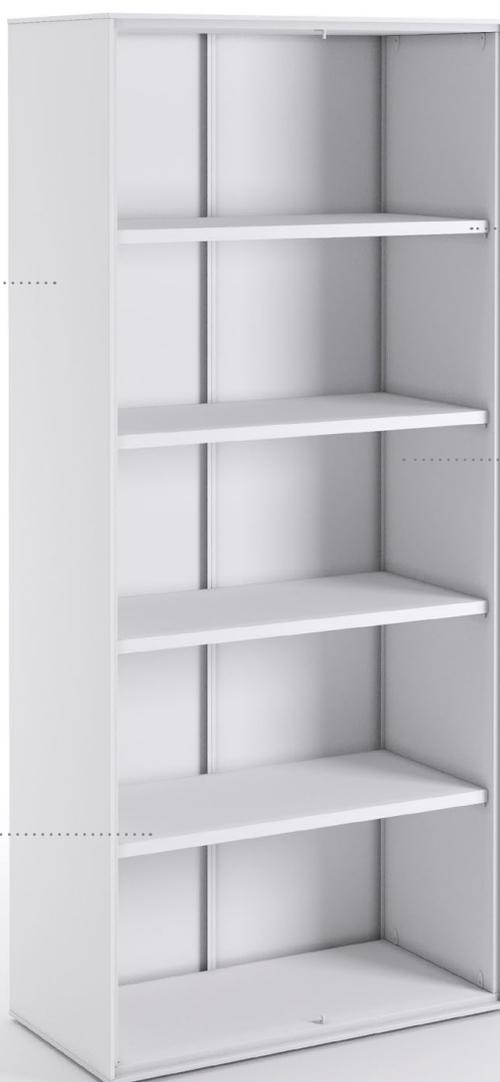
■ Ripiani metallici realizzati in lamiera d'acciaio 8/10 di prima scelta DC01 - UNI EN 10130, presso piegata. Spigoli esterni arrotondati con raggio di curvatura di 2 mm.
